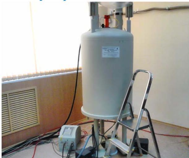
Двухканальный спектрометр позволяет проводить ЯМР эксперименты в поточном режиме:
