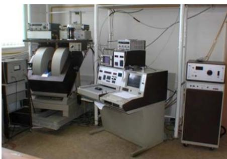
**ЭПР спектрометр Bruker ESP 300**
