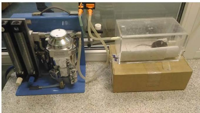
Установка для газовой анестезии лабораторных животных.
