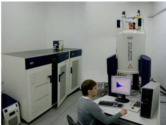
Двухканальный ( $X$ ,  $^1\text{H}$ ) спектрометр твердого тела, оборудованный высокомоощным (1кВт) передатчиком, температурным блоком, пневматическим блоком для экспериментов с вращением образца под “магическим углом” (MAS).
