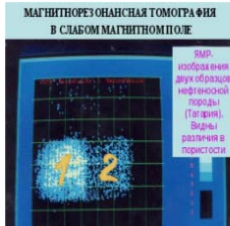
ЯМР-изображения в поле 0,15 мТл двух образцов нефтеносной породы (Татария). Видны различия в пористости
