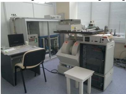
Стационарный спектрометр ЭПР X-диапазона (9 ГГц).
