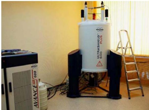
Трехканальный спектрометр позволяет проводить ЯМР эксперименты:
