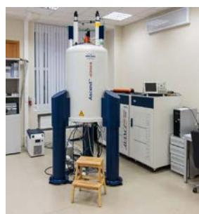
Спектрометр для исследования образцов в твердой фазе: кристаллов, порошков, слабоупорядоченных сред и материалов, гелей, жидких кристаллов, аморфных сред, наноструктур (цеолитов, силикатов) и т.п., а также для исследования процессов диффузии и получения микротомографических изображений.
