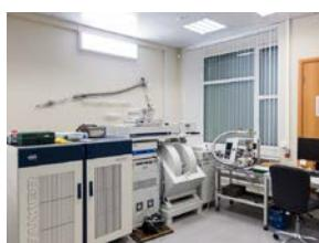
Спектрометр ЭПР ( $\lambda = 3.2$  см, X-диапазон) для изучения парамагнитных центров, локализованных в твердых телах, жидкостях, растворах, включая водные растворы и газах. Спектрометр предназначен для работы как в CW-, так и в FT-режиме.
