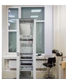
Спектрометр позволяет получать спектры ЯМР и ЯКР для исследования твердых тел, металлов, стекол и магнитоупорядоченных образцов.
