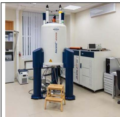
ЯМР спектрометр Bruker 400 МГц WB для исследования образцов в твердой фазе: кристаллов, порошков, слабоупорядоченных сред и материалов, гелей, жидких кристаллов, аморфных сред, наноструктур (цеолитов, силикатов) и т.п. Комплектация прибора позволяет исследовать процессы диффузии и получать микротомографические изображения объектов.
