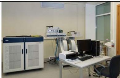
Спектрометр ЭПР Bruker Elexsys E580 ( $\lambda = 3.2$  см, X-диапазон) для изучения парамагнитных центров, локализованных в твердых телах, жидкостях, растворах, включая водные растворы и газов. Спектрометр предназначен для работы как в CW-, так и в FT-режиме.
