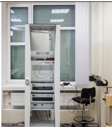
ЯМР/ЯКР спектрометр Tescmag Redstone 1-500 МГц позволяет получать спектральные и релаксационные характеристики ЯМР и ЯКР при исследовании твердых тел, полимеров, металлов, стекол и магнитоупорядоченных образцов.
